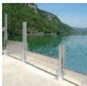
La protection est constituée de poteaux chevillés aux supports entre lesquels viennent s'emboîter des éléments palplanche modulables. Les éléments sont en aluminium 6005 T5 traitement marine. L'étanchéité est assurée par des joints.
